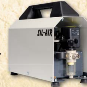
Kompressor Sil-Air 20a Ansaugleistung: 17l/Min max. Druck: 6 bar 30 dBA, 17 kg, 1,5 l Tank Flüsterleiser Automatikkompressor Artikel-Nr. 900205
