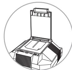
**VORSICHT:** Beim Betrieb des Projektors auf ausreichende Belüftung achten. Die Luftschlitz auf der Rückseite und an den Seiten des Projektors nicht blockieren.
